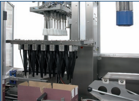
Imbuti centroratori per cartoni con alveari preinseriti Centering funnels for cartons with premade partitions Entonnoirs de centrage pour cartons avec ruche préintroduites
