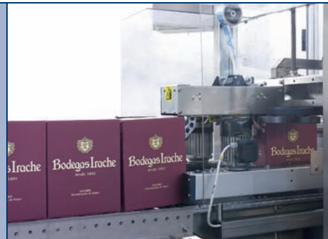
Unità di nastratura per chiusura delle falde superiori ed inferiori Taping unit for upper and lower edges sealing Unité d'application de ruban pour la fermeture des bords supérieurs et inférieurs
